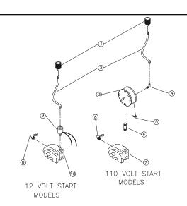
FUEL SYSTEM PARTS LIST FOR 12v AND 110v MODELS
